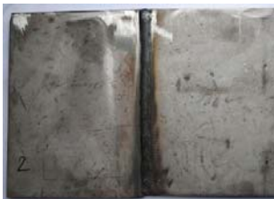
Slika 1 - Lice zavarenog spoja ploča debljine 10 mm
