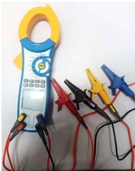
Slika 1- Uređaj za mjerenje električne snage u monofaznim i trofaznim sistemima PKT-1660
