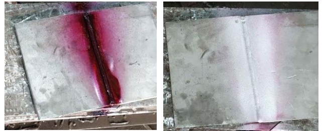
Slika 3 - Penetrantska kontrola zavarenog spoja limova 10 mm
