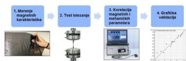
Slika 6 - Postupak kalibracije za 3MA sensor
